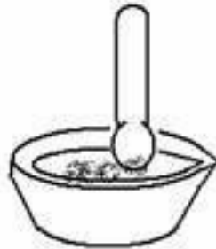
Gambar 46. Preparasi sampel berupa padatan menggunakan mortar
