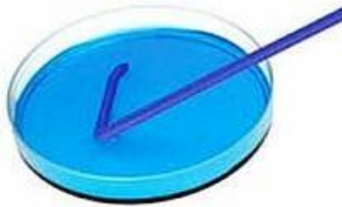
Gambar 27. Penggunaan batang penyebar
