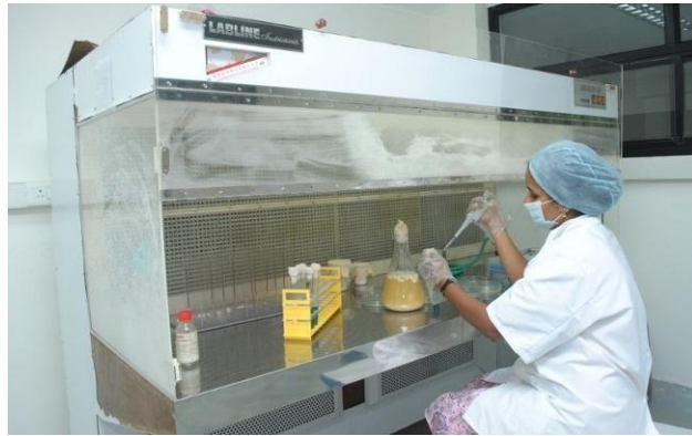
Gambar 2. Cara bekerja menggunakan Laminar Air Flow (LAF)
