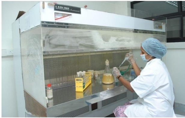
Gambar 2. Cara bekerja menggunakan Laminar Air Flow (LAF)
