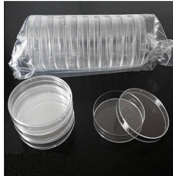
Gambar 11. Cawan petri kaca (kiri) dan cawan petri disposable (kanan)
