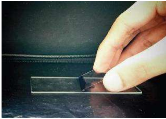
Gambar 1. Teknik penggunaan object glass dan cover glass (Sumber : www.arauco.org )
